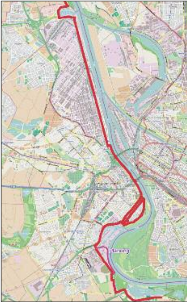
Hochwasserschutzlinie am Rhein: Rheinhauptdeich (Stand 2014)
