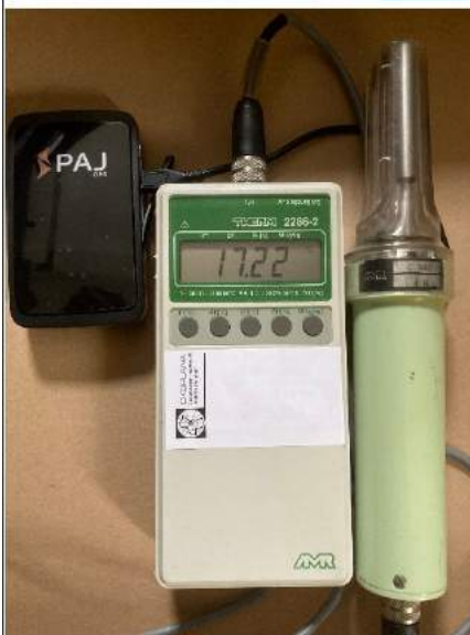
Abbildung 5: Messfahrzeuge und Messtechnik zur linienhaften Erfassung der Lufttemperatur 2 m ü.G. (Foto: ÖKOPLANA)
