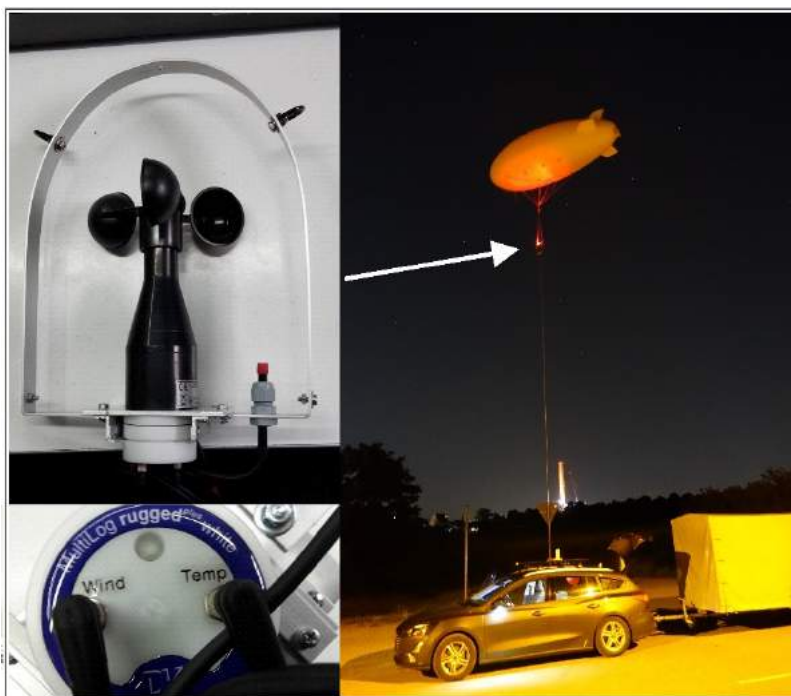
Abbildung 7: Messtechnik zur Erfassung der Lufttemperatur und des Windes mit einem Fesselballon (Foto: ÖKOPLANA)
