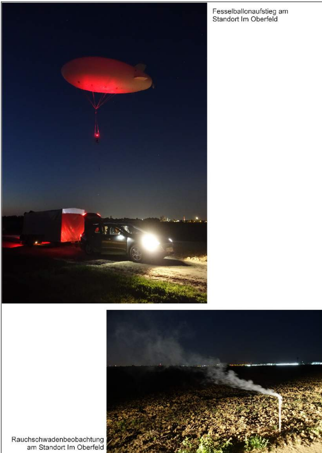
Abbildung 18: Fesselballonaufstieg und Rauchschwadenbeobachtung (21:30 Uhr) am Standort 1 Im Oberfeld, fotografische Dokumentation (Foto: ÖKOPLANA)
