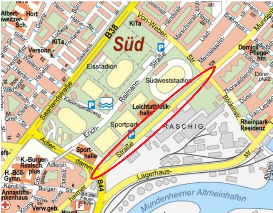
Stadteinwärts sind eine PKW-Spur und eine separate Busspur mit seitlich geführtem Radstreifen (auf Fahrbahnniveau) geplant. Der geplante Gehweg ist im südlichen Seitenbereich, zwischen dem bestehenden Grünstreifen und den angrenzenden Grundstücken der Fa. Raschig, angeordnet.
