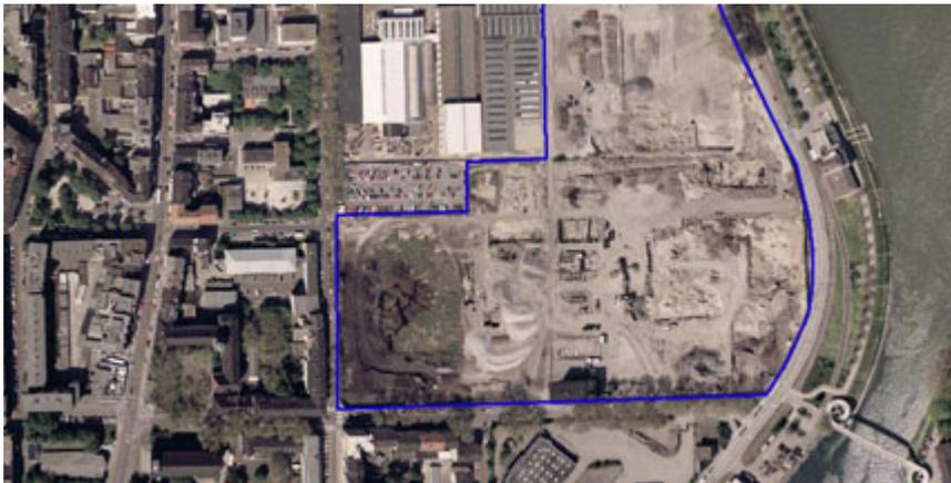
In den Jahren 1999 bis 2000 wurde das sieben Hektar große Gelände der ehemaligen Großgießerei Halberger Hütte saniert: 52.000 Tonnen Fundamente und Unterflurbauwerke wurden ausgehoben und recycelt, 2.600 Tonnen Abluftschlämme wurden auf der Sonderabfalldeponie Gerolsheim entsorgt, 340.000 Tonnen Gießereisande wurden ausgehoben und der Deponie Nonnenwühl (Stadt Speyer) zur Wiederverwertung als Deponiebaumaterial zugeführt.
