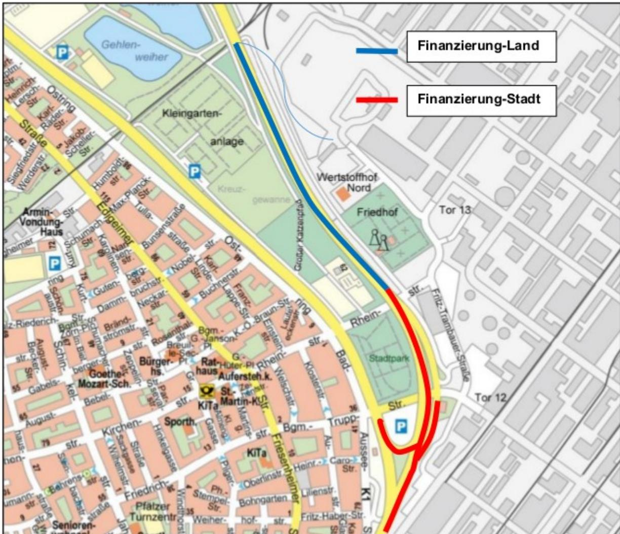
Die Maßnahme soll in mehrere Bauabschnitte mit einer Länge von ca. 120 m aufgeteilt werden. Bei der Baudurchführung ist es erforderlich eine Fahrspur der betroffenen zwei Richtungsfahrbahnen auf einer Länge von ca. 250 m zu sperren. Damit kann der Verkehr auf einer Richtungsfahrbahn während der Bauarbeiten einspurig fließen.
