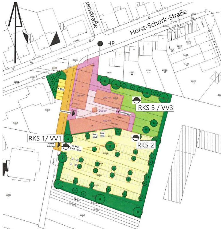
Abbildung 6: Ausschnitt aus Übersichtsplan Probestellen Bodenuntersuchung
