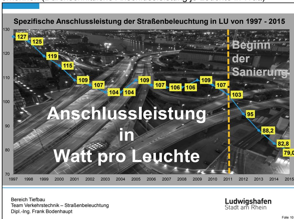
Wenn man sich die Dimension einer Tonne CO<sub>2</sub> veranschaulicht, so kann man ermessen, was es bedeutet, wenn wir durch die Sanierung der Straßenbeleuchtung rund 1.364 Tonnen jährlich einsparen. (Basis 2000)
