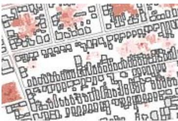
Ergänzend zu der Starkregengefahrenkarte hat die Stadtverwaltung auf Grundlage des digitalen Geländemodells eine Muldenkarte erstellen lassen. Da sich in Mulden und Senken bei Starkregenereignissen das Wasser sammeln kann, ermöglicht diese Karte eine erste Einschätzung der Gefährdungslage eines Anwesens. Die Karte ist als flächendeckendes Grob screening zu verstehen und besitzt auf Grund der Datendichte des digitalen Geländemodells mit
