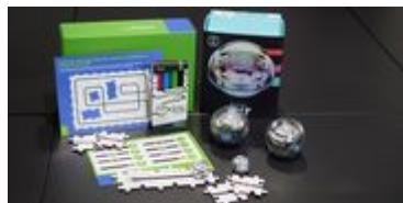
Der Ozobot ist ein Miniroboter und lässt sich mittels Strichen und Farbcodes steuern. Er kann sich auf der Stelle drehen, im Zickzack oder im [...]
