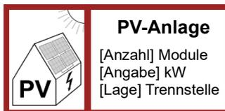
Für PV – Anlagen sind Detailpläne anzufertigen (Dachansicht). Der Leitungsverlauf zwischen den PV – Segmenten und dem Wechselrichter-Trennschalter ist grafisch darzustellen. Die Lage des Trennschalters und einem eventuell vorhandenen Notausschalter ist auch im Geschossplan anzugeben.
