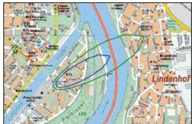
Modellierte Ausbreitung der Rauchwolke mit Hilfe des Systems für Ausbreitungsmodellierung bei Schadstofffreisetzung („SAMS“)
