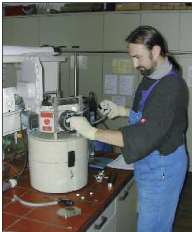
Wartung eines automatischen Probenahmegerätes
